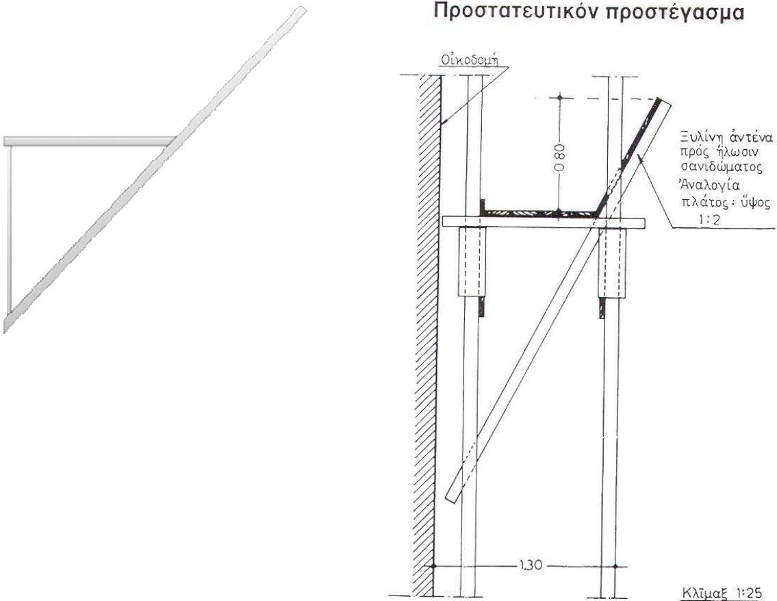
Η κατασκευή θα αποτελείται από μεταλλικά πλαίσια κατασκευασμένα από γαλβανισμένους εν θερμώ κοιλοδοκούς διαστάσεων 50/100/2mm που θα απέχουν μεταξύ τους (1) m ή άλλη απόσταση που θα υποδεικνύεται από την υπηρεσία. Το συνολικό μήκος της κατασκευής θα είναι πενήντα (50) m περίπου. Η γεωμετρία των πλαισίων θα είναι σύμφωνη με την ισχύουσα νομοθεσία.
